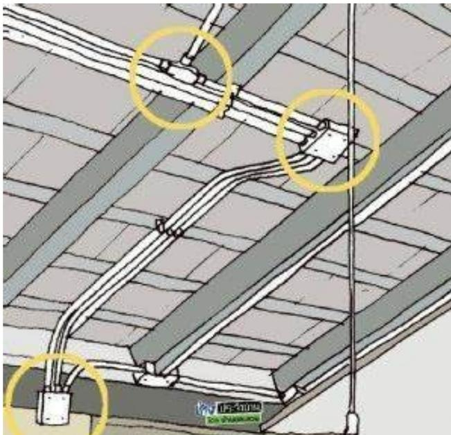
Instalação dos cabos de fibra óptica e cabos de rede utilizando eletrodutos rígidos de sobrepor com dimensões mínimas de 20mm, com curvatura mínima de 250mm e caixas de passagens a cada 30 metros.
